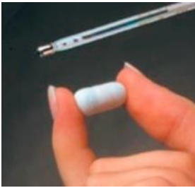
Figuur 3. Een voorbeeld van een telemetrische capsule die wordt gebruikt om de kerntemperatuur te meten
