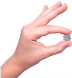
Figuur 4. Een voorbeeld van een iButton die wordt gebruikt om de huidtemperatuur te meten
